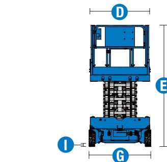
(1) En el sistema métrico, altura de trabajo = altura de la plataforma + 2 m.
