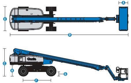
(1) 作業高さのメートル換算値は、作業台高さに2mを追加。米国単位では、作業台高さに6フィートを追加。
